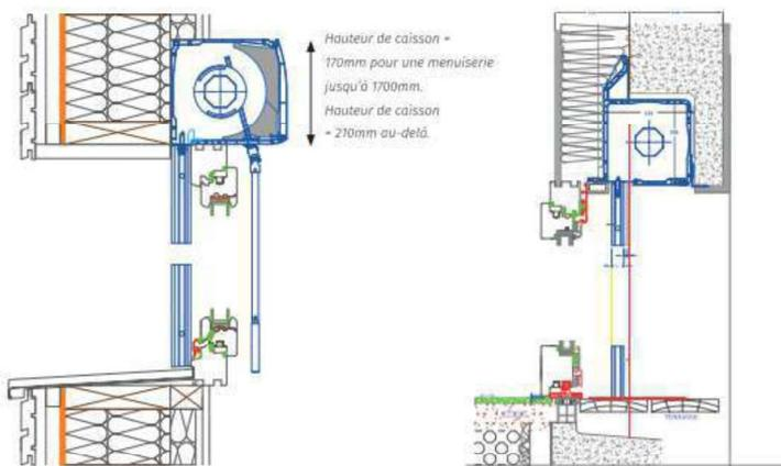
Pose en monobloc **intérieur** ou **extérieur**, sur **béton** ou **ossature bois** avec menuiseries **bois** ou **mixte bois-alu**. Possibilité de caisson titan.
